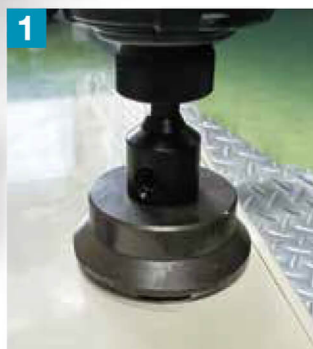
1 本製品を取り付け、穴あけ作業をします。
